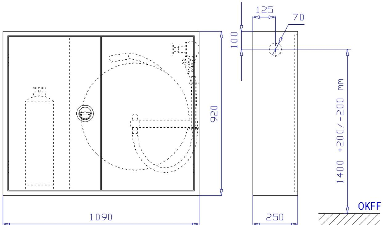
STEIN Aufputzschrank Bauart C 1090 x 920 x 250 mm (Breite x Höhe x Tiefe) nach DIN 14461-1. Aus 1 mm verzinktem Stahlblech gekantet und verschweißt, frontseitige Stöße verschweißt und verschliffen. Belüftung über Türspalt. Vier Montagebohrungen in der Rückwand. Mit Schlauchtrommelhalterung, seitlich abgeschottetes Fach zur Aufnahme eines 12 kg Handfeuerlöschers. Wasseranschluss Ø 70 mm - Bauart RS (rechts - Seitenwand), wie abgebildet, auf Wunsch auch andere Positionen.
