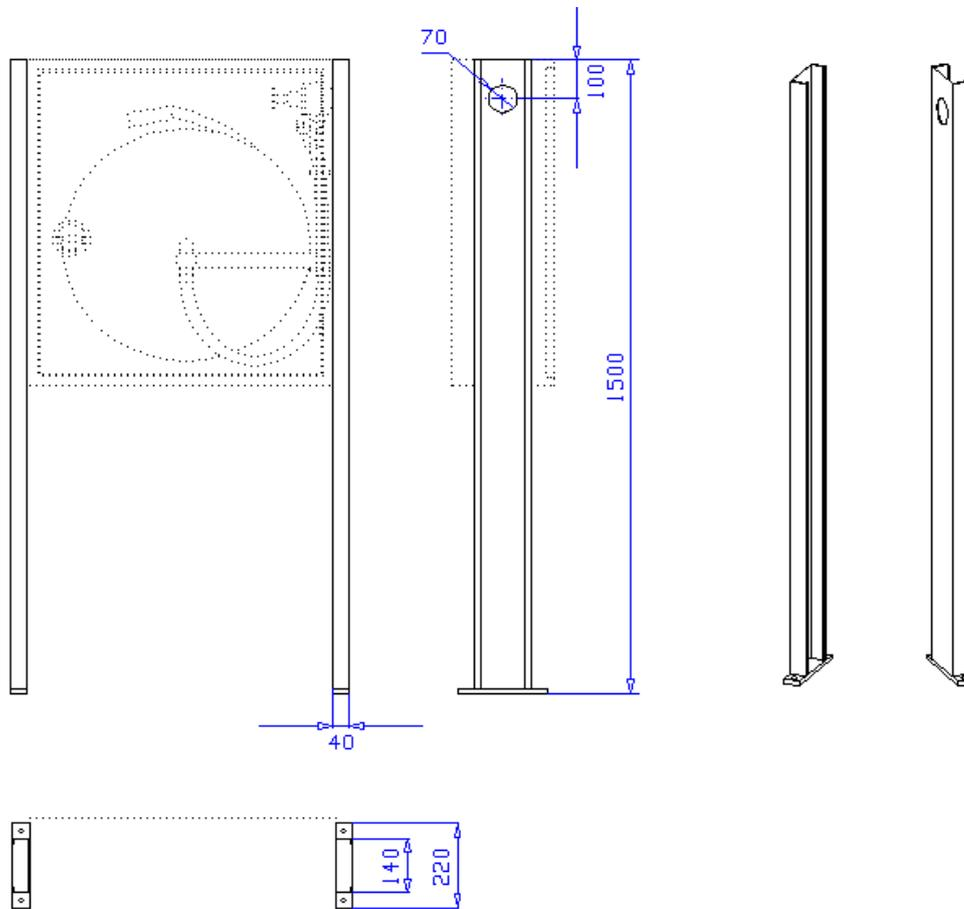
Das Leichtbau-Profilgestell ist zur wandunabhängigen Aufstellung von Schränken vorgesehen. Die 140 mm breiten Profile sind aus 2 mm verz. Stahlblech gekantet und sind mit einer WA-Bohrung sowie mit Bohrungen zur Montage des Schrankes versehen. An den Füßen befinden sich Flanschplatten mit Bohrungen, um das Gestell mit dem Boden zu verschrauben. Das Gestell kann für alle gängigen Wandhydranten eingesetzt werden.
